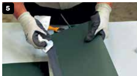
Schoonmaken met een droge doek. Stap 3 herhalen op plaatsen waar nog resten PIGMENTO blijven.
