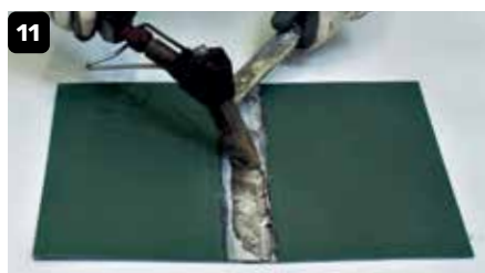
Breng Zinn 7 aan over de lengte van de soldeernaad. Soldeer de bladen.
