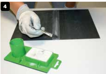
4 Breng plaatselijk Zinn 7 aan om goed te kunnen solderen. Breng de 2 te solderen platen samen volgens schema p 6 - 7.
