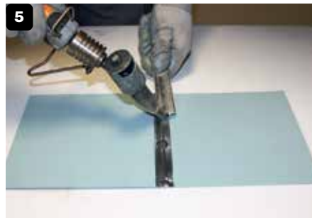
Puntsoldering van de te verbinden delen.
