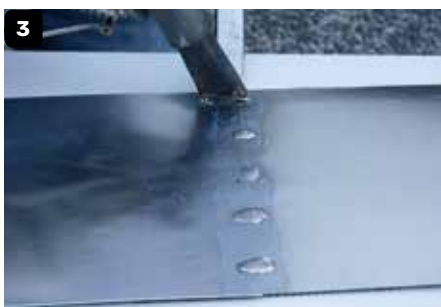
3 Vertinnen van de soldeerbout op de ammoniaksteen. Puntsoldering van de te solderen delen.
