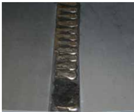
Uitsmeren van het soldeersel
