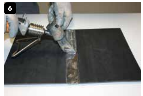
6 Breng Zinn 7 aan over de lengte van de soldeernaad. Soldering van de bladen (versterkte soldering).
