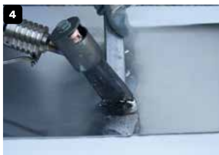
4 Realisatie van een gladde soldering. Aanbrengen van extra toevoegmetaal.
