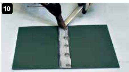
Puntsoldering van de samen te voegen delen.
