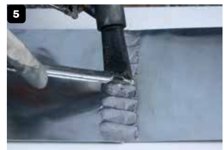
5 Realisatie van een geribde versterkte soldering op de gladde soldering.
