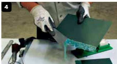
De blazen op de behandelde delen verwijderen met een spatel.
