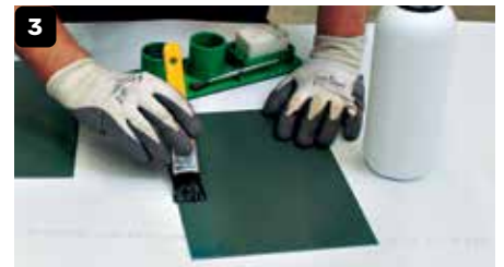
Behandeling van het gepigmenteerde oppervlak met een afbijtmiddel, laat het enkele seconden inwerken.
