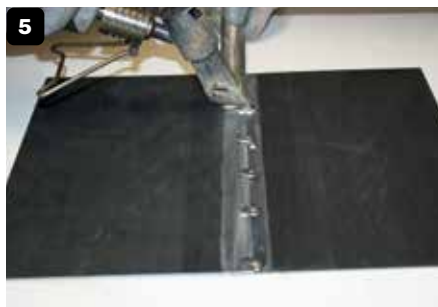
5 Punt soldering van de te assembleren delen.
